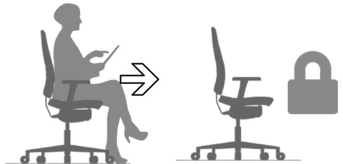
Con sistema de freno de seguridad ajustable que permite que la silla esté ligeramente frenada cuando nos levantamos del asiento, a fin de evitar que la silla se desplace cuando se deja de utilizar. Con el usuario sentado, la rueda gira libremente y la silla se puede mover. Con la silla sin usuario, sin peso, la rueda ejerce resistencia al movimiento. Dispone en la parte inferior de un tornillo para ajustar la fuerza del frenado o la desactivación del mismo.
